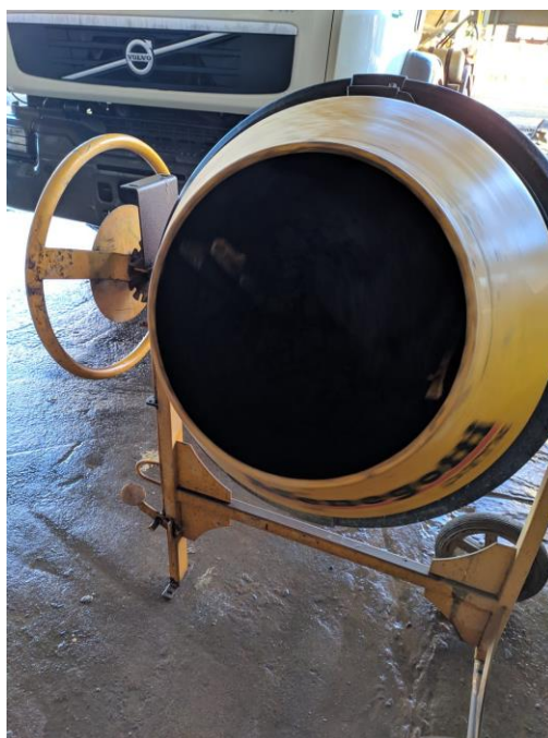
Figura 5 - Mistura dos traços na betoneira
