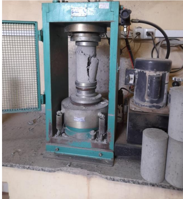
Figura 10 – Prensa hidráulica utilizada no teste de rompimento dos CPs.
