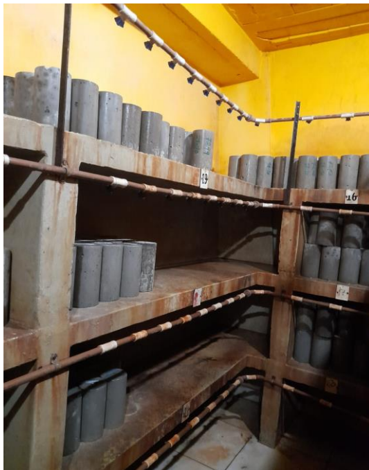
Figura 8 - Processo de cura dos CPs em câmara úmida
