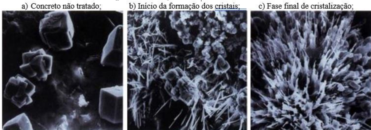
Figura 4 - Formação dos cristais no interior do concreto
