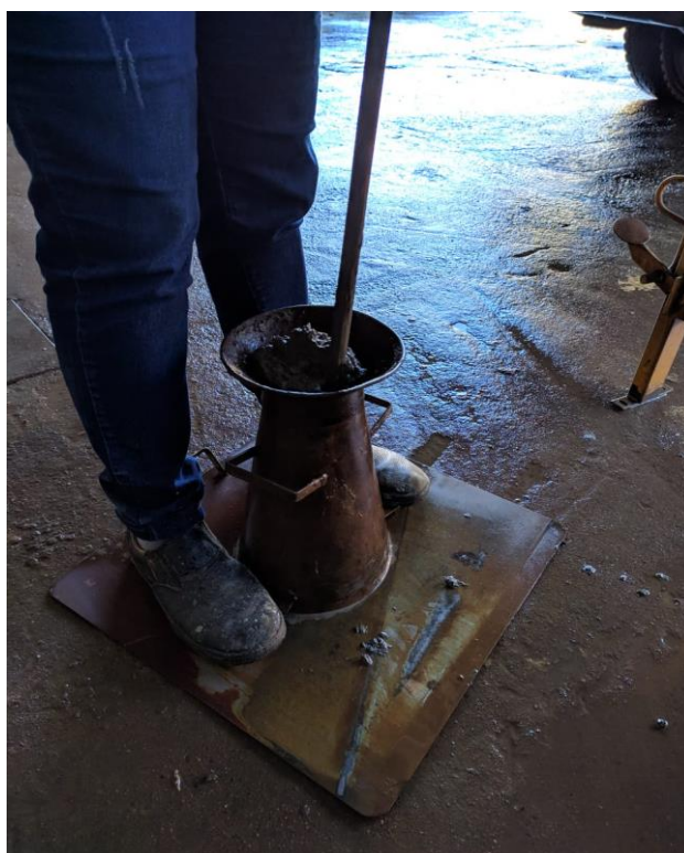
Figura 6 - Realização do teste de abatimento do tronco de cone (slump).
