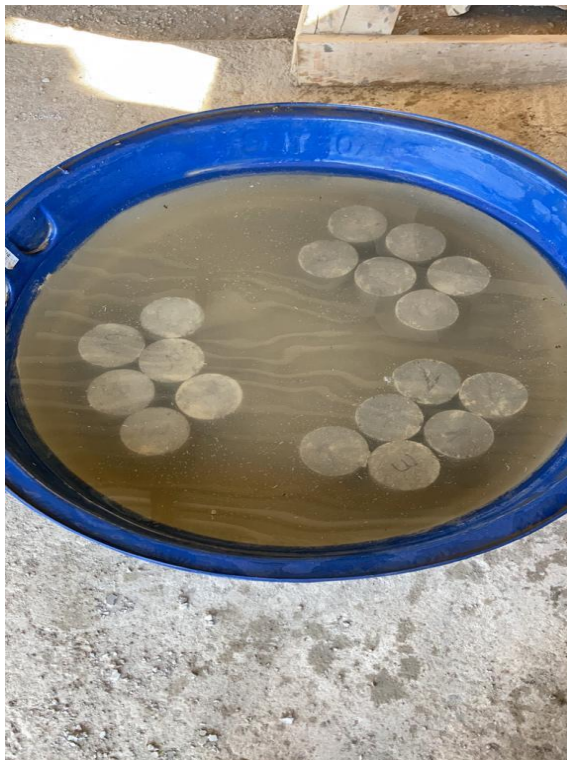
Figura 12 - CPs submersos para ensaio de absorção
