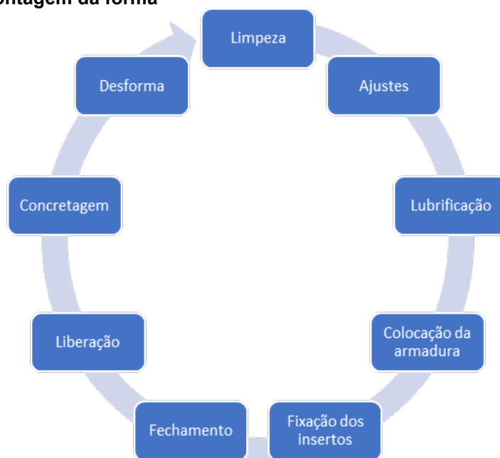
Figura 3: Ciclo de montagem da fôrma
